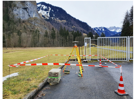
Abbildung 4: Statische GNSS-Messungen am Jaunpass
