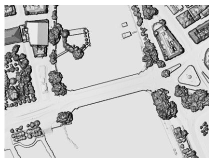
Abbildung 15: swissSURFACE 3D Raster nach den Verbesserungen mittels Gewässervektoren und spike-free Algorithmus
