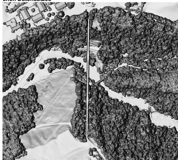
Abbildung 4: Gleicher Ausschnitt, multidirektionale Reliefschattierung des DOM swissSURFACE3D Raster
