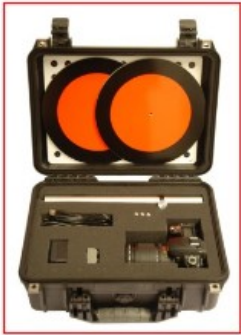
Kalibrierte Spiegelreflexkamera (Zoomobjektiv, Objektivwechsel)
