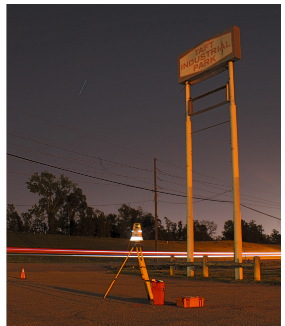
Abbildung 4: Foto des TSACS-Systems (basierend auf einem TS60) während einer Messung
