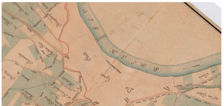
Abb.17: Fehlerhafte Grundlage der Dufourkarte (Abb.18): Die Überlagerung mit der aktuellen Landeskarte 1:25 000 belegt, dass die Rheinbrücke bereits in dieser Grundlage, die anhand der fünf roten Passpunkte in einem GIS ins heutige Landeskoodinaten-system transformiert wurde, rund 100 m flussabwärts eingetragen ist.
