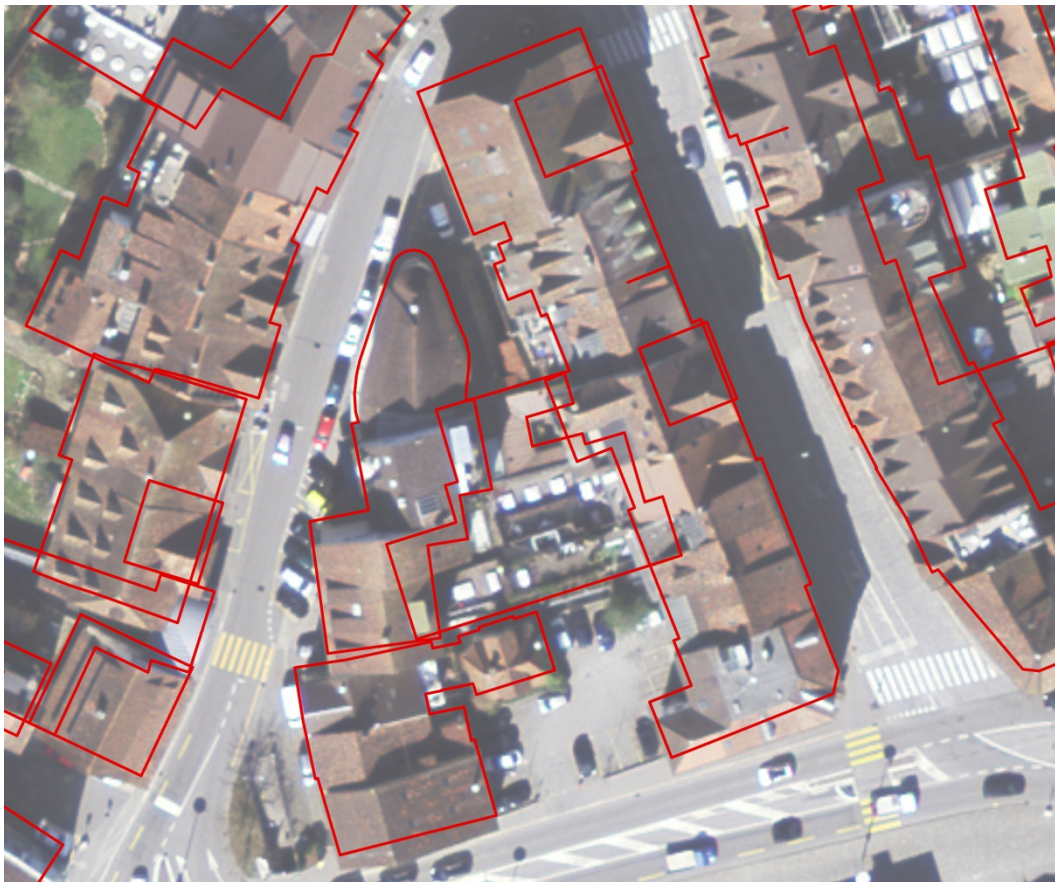
Abbildung 6 Beispiel einer Flächenprojektion auf das Gelände aus 3D-Gebäudedächern in einem komplexen Gebiet.
