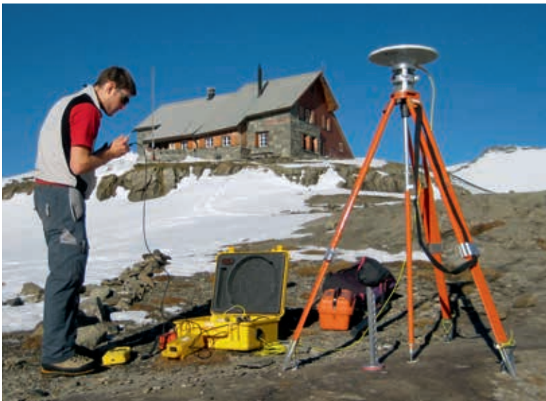
GPS-Messungen vor der Muttsee-Hütte (GL). Mit der neuen Landesvermessung LV95, den permanent betriebenen Referenzstationen des Automatischen GPS Netzes der Schweiz (AGNES) und dem Positionierungsdienst swipos macht swisstopo landesweit hochpräzise GPS-Vermessungen möglich.
