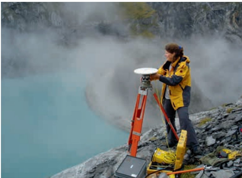
Hochpräzise GPS-Messungen im dreidimensionalen Grundlagentnetz für das Pumpspeicherwerk «Linthal2015» (GL).
