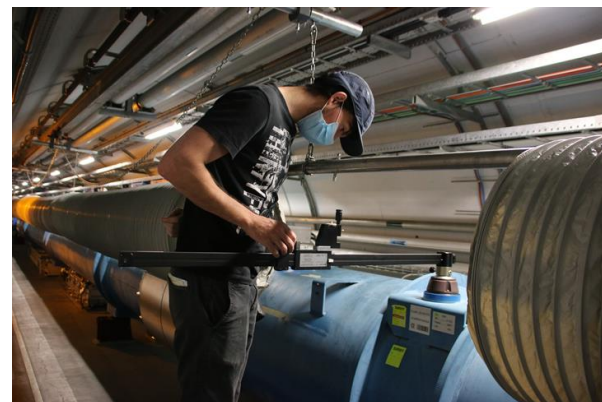
Ecartométrie / Wire offset measurements
