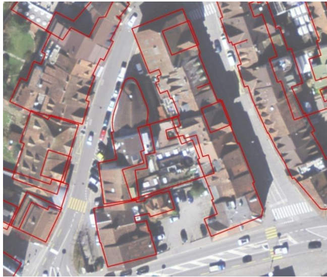
Abbildung 4: Beispiel der Geländeprojektion von 3D-Dächern in einem komplexen Quartier.
