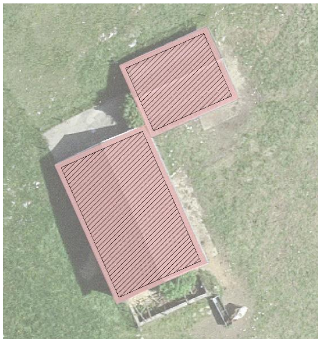
Abbildung 5: Die zwei vorhandenen Varianten von Grundrissepolygonen: In Rosa dargestellt, Grundrissepolygone mit Dachüberständen (in den Kantonen BE, FR, JU, LU, SG, SH, SO und SZ) und schwarz schraffiert Grundrissepolygone mit den entfernten Dachüberständen.
