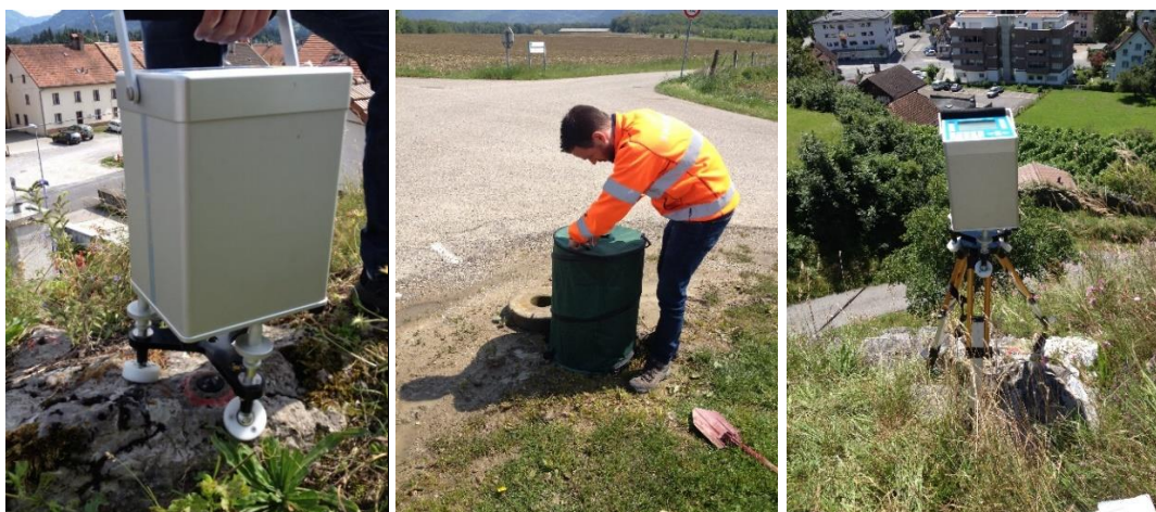
Abbildung 10-1: Stationierung des CG-5. Nylonfüsse, Wind- und Sonnenschutz, hohes Stativ
