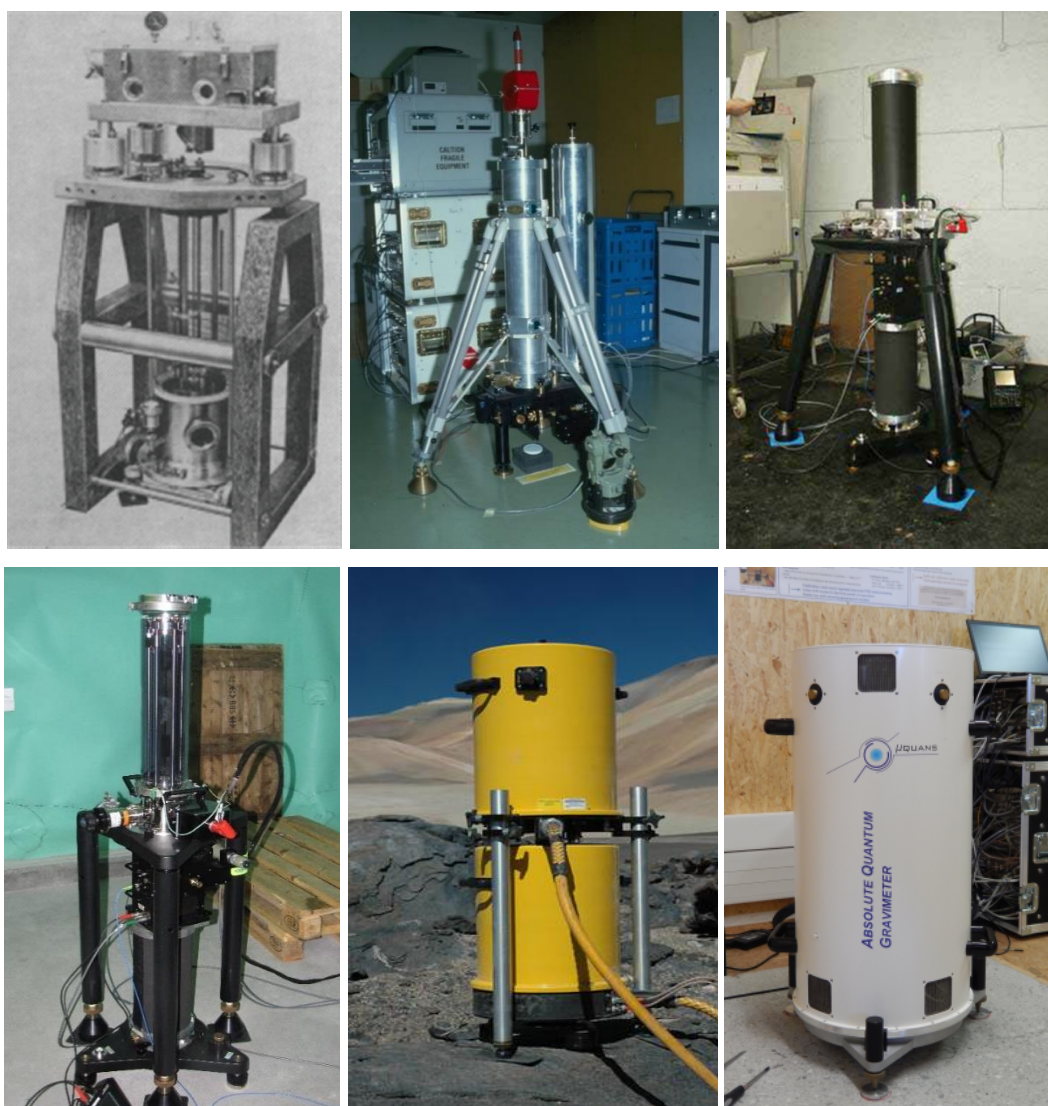
Abbildung 1-2: Einige Absolutgravimeter: obere Reihe: IMGC, JILAg, FG5; untere Reihe: FG5-X, A10, \mu\text{QUANS} Absolute Quantum Gravimeter AQG
