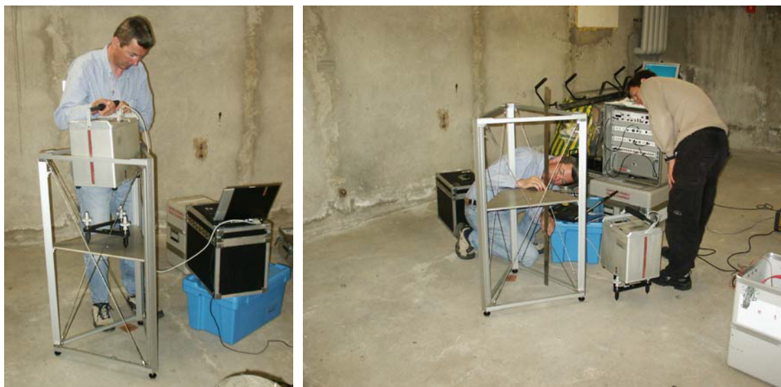
Abbildung 11-1: Gradientenmessung in Brig mit dem Stativ des METAS und dem Scintrex CG-3M
