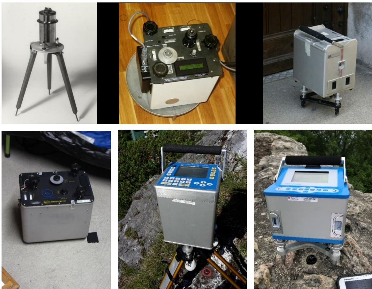
Abbildung 1-1: Einige in der Schweiz eingesetzte Relativgravimeter. Obere Reihe: Worden, LaCoste&Romberg, Scintrex CG-3; untere Reihe: ZLS Burris, Scintrex CG-5, Scintrex CG-6
