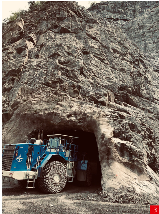
Abb. 3: Pneulader im Steinbruch Zingel in Seewen (SZ), wo Hartstein aus Kieselkalk abgebaut und teils unter Tage aufbereitet wird.
