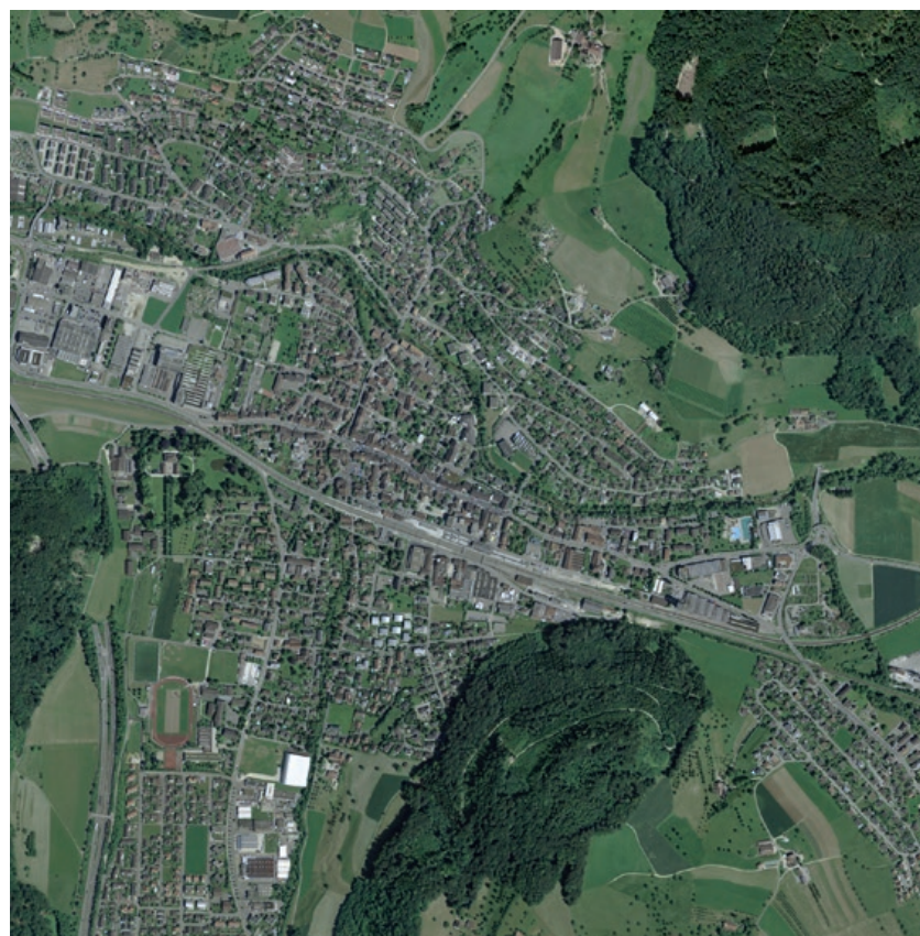
Abb. 15: Ältestes swisstopo-Luftbild von Sissach: Aufnahme 719 vom 13. Mai 1931 mit der Wild-Messkammer 17 mit einer Brennweite von 165 mm aus einer Flughöhe von 3050 m. Der Abstand der Rahmenmarken auf der Glasplatte beträgt 13 x 13 cm. Der Vergleich mit der streng nach Norden ausgerichteten Abb. 16 zeigt, dass die vermutlich freihändig gehaltene Kamera im Zeitpunkt der Aufnahme leicht nach Osten verdreht war.
