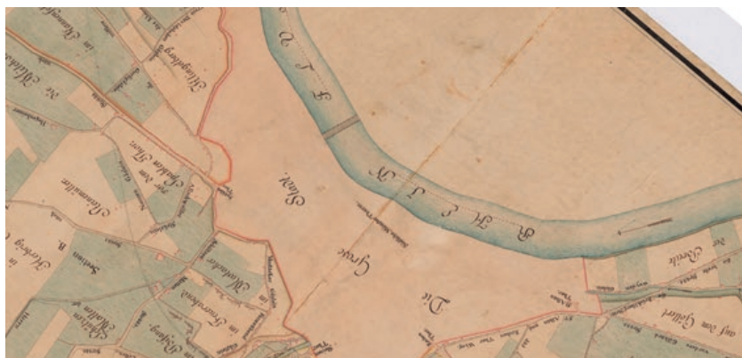
Abb.17: Fehlerhafte Grundlage der Dufourkarte (Abb.18): Die Überlagerung mit der aktuellen Landeskarte 1:25 000 belegt, dass die Rheinbrücke bereits in dieser Grundlage, die anhand der fünf roten Passpunkte in einem GIS ins heutige Landeskoordinatensystem transformiert wurde, rund 100 m flussabwärts eingetragen ist.
