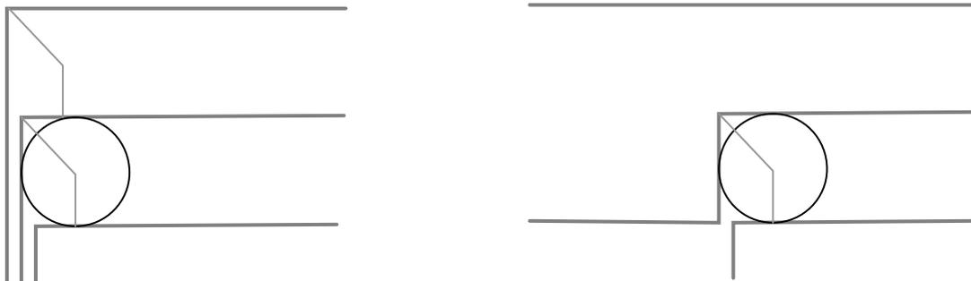
**Abbildung 4** Systematische Verfälschung beim Zusammenkommen von Flächen mit stark unterschiedlicher Neigung verglichen mit einer Situation mit "sinnvoller" Gerippelinie.
