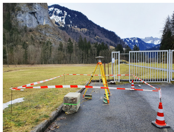
Figure 4: Mesures GNSS statiques au col du Jaun
