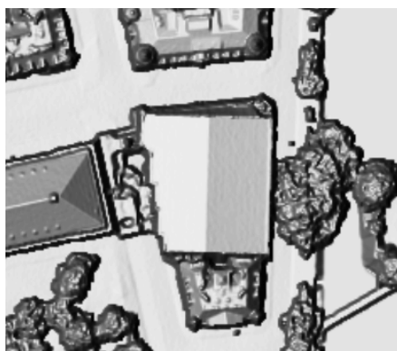
Figure 14: Meilleure présentation après l'application de l'algorithme spike-free
