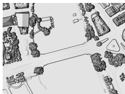
Figure 15: swissSURFACE 3D Raster après les corrections avec les vecteurs TLM et l'algorithme spike-free
