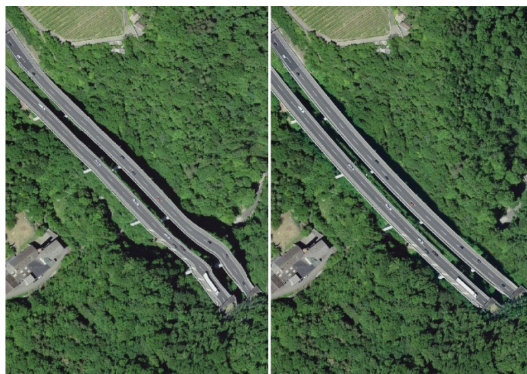
Exemple d'un pont avant (gauche) et après correction (droite)
