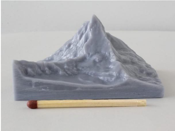
Figure 5: Impression 3D à partir du format de fichier STL
