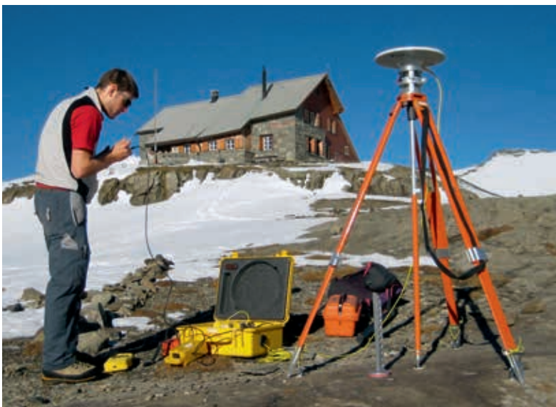
Mesures GPS en contrebas de la cabane du Muttsee. Avec la nouvelle mensuration nationale MN95, les stations de référence permanentes du réseau GPS automatique suisse (AGNES) et le service de positionnement swipos, swisstopo rend l'exécution de levés GPS de haute précision possible dans toute la Suisse.
