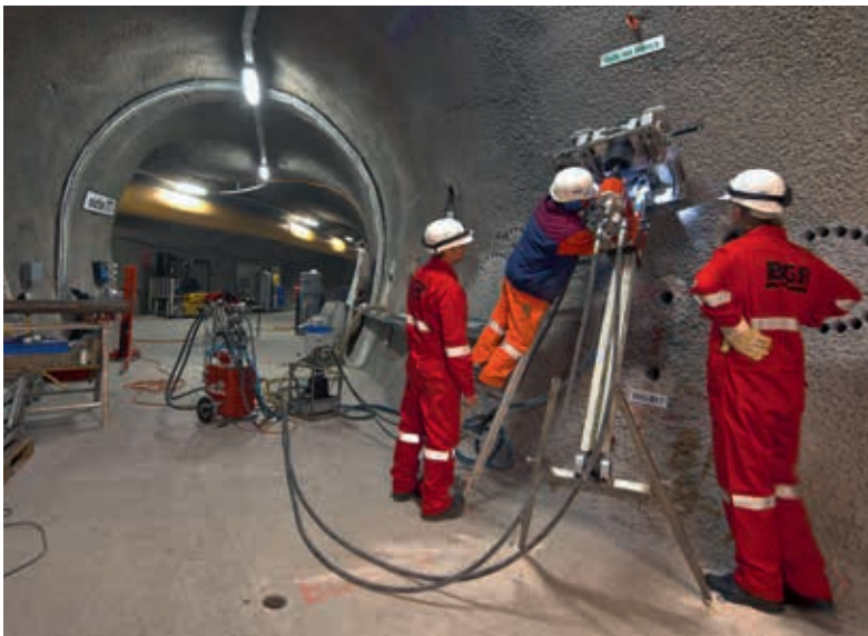
Des chercheurs de l'Institut fédéral allemand des géosciences et des ressources naturelles («Bundesanstalt für Geowissenschaften und Rohstoffe, BGR») effectuent un forage dans le laboratoire de roches du Mont Terri (JU) en vue de recueillir des carottes d'argile à Opalinus.
