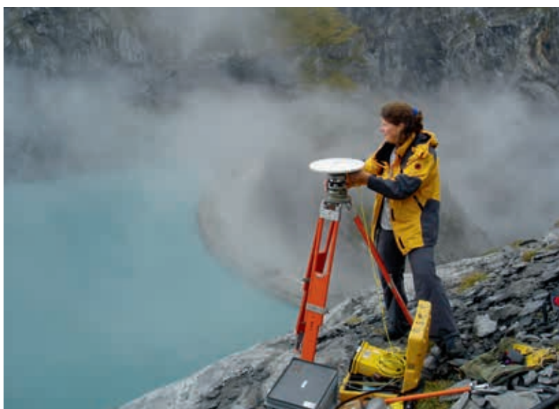
Mesures GPS de haute précision sur un point du réseau de base tridimensionnel établi pour une station de pompage-turbinage (Linthal 2015, GL).
