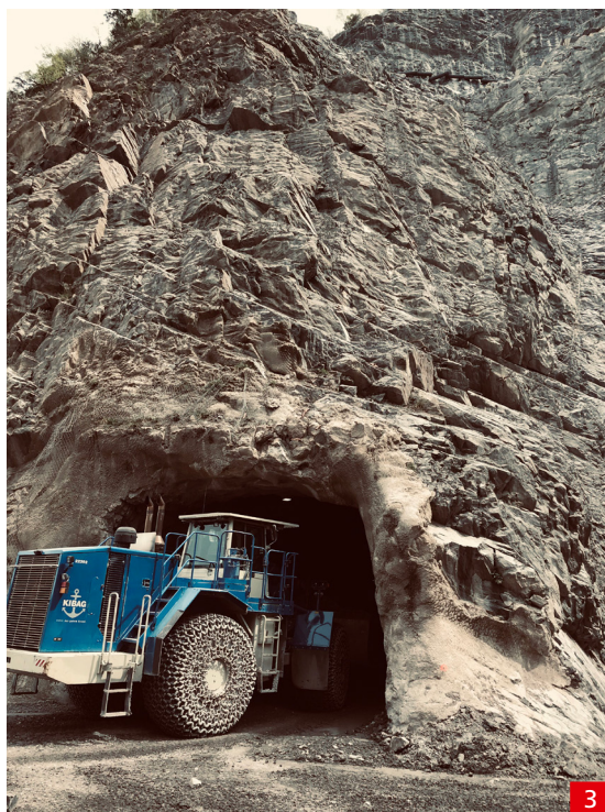
Fig. 3 : Chargeuse dans la carrière de Zingel à Seewen (SZ), où la roche dure à base de calcaire siliceux est extraite et qui est partiellement traitée en souterrain.
