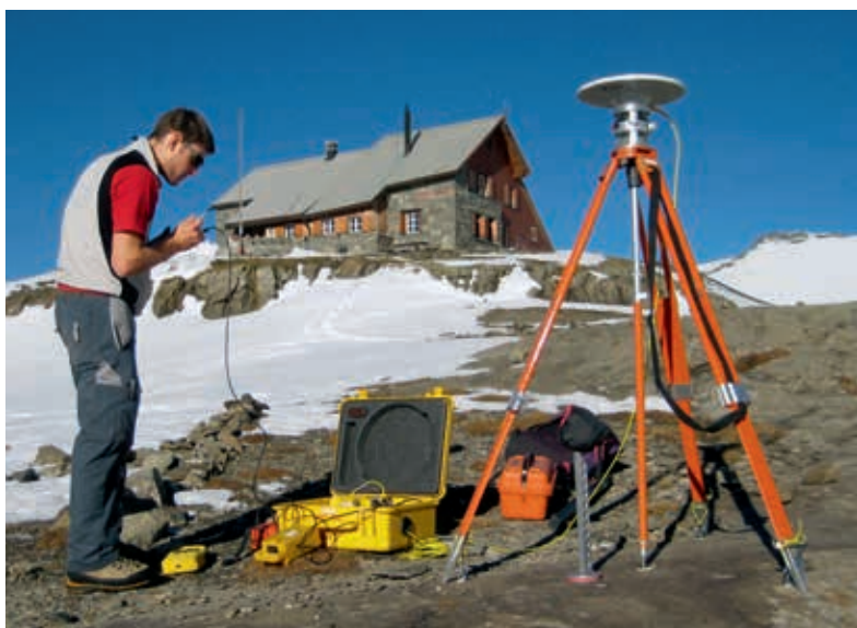
Misurazioni GPS davanti al rifugio di Muttsee (GL). Con la nuova misurazione nazionale MN95, le stazioni di riferimento gestite in via permanente, la rete automatica GNSS svizzera (AGNES) e il servizio di posizionamento swipos, swisstopo assicura a livello nazionale misurazioni GPS ad alta precisione.
